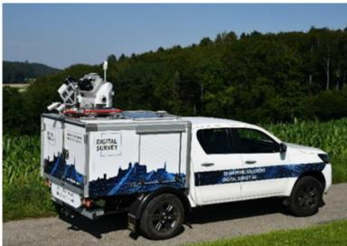
Neben den herkömmlichen Verfahren (tachymetrische und satellitengestützte Messungen) wird in diesem Los auch das 3D Mobile Mapping eingesetzt. Mittels Laserscanning und hochauflösender Kameras werden mit diesem System vor allem die sichtbaren Gebäudeecken vermessen.
